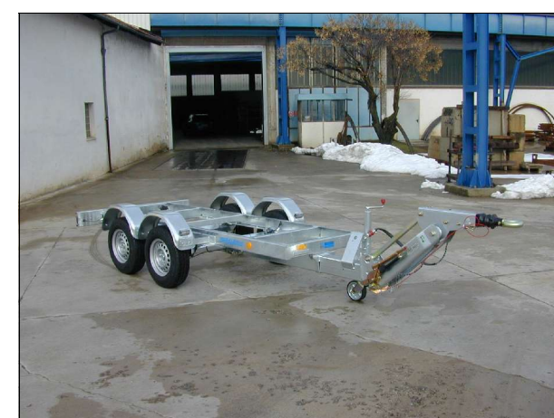
Rimorchio tipo BD 3500 TG3T-TR 3500 kg PTT – telaio 3525x990 mm con timone ad altezza regolabile predisposto per applicazione motocompressore
