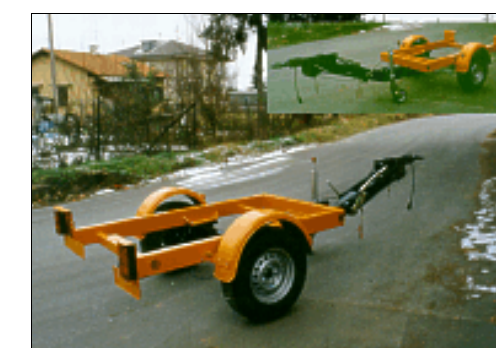
Rimorchi tipo BD 1800 SSG – BD 1800 SSG-TR con telai predisposti per applicazione attrezzature
