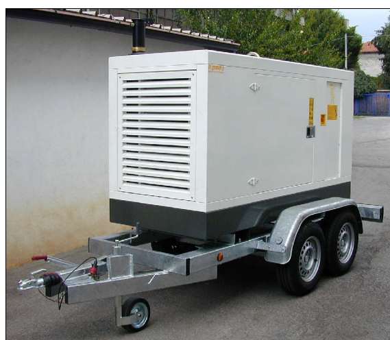
Rimorchio tipo BD 2000 TL1T 2500 kg PTT – telaio 3000x1000 mm a uso speciale gruppo elettrogeno
