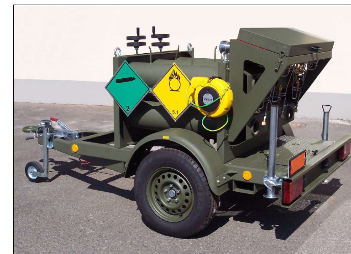
Rimorchio tipo BD 085 VZE/OT – 900 kg PTT Allestito con apposita struttura per trasporto ossigeno compresso in bombole in condizioni ADR. Veicolo con occhione e verniciatura secondo standard Nato
