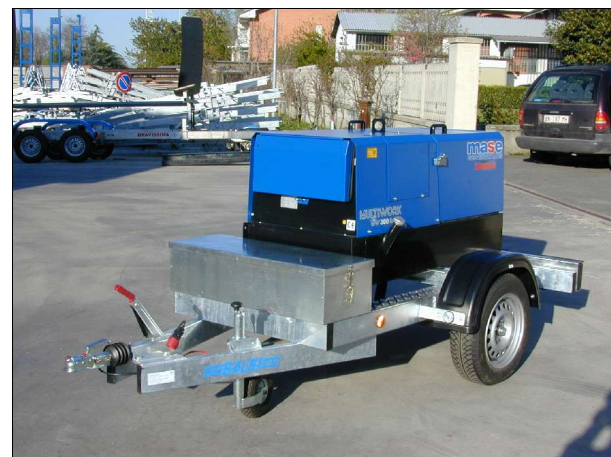
Rimorchio tipo BD 750 MS1 750 kg PTT – telaio 2000x1000 mm a uso speciale motosaldatrice
