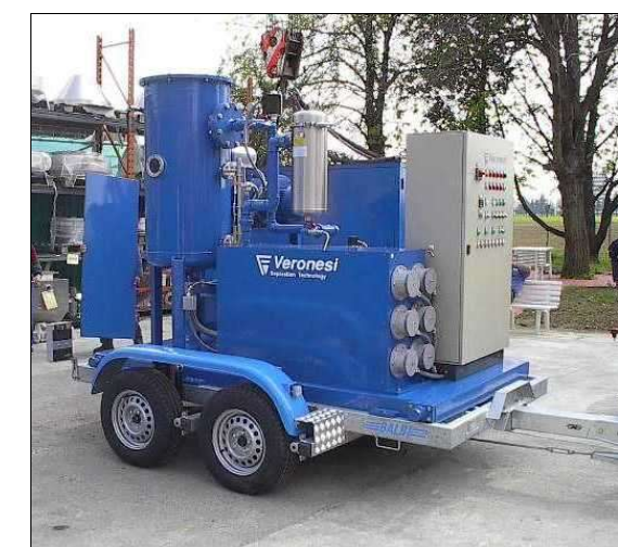
Rimorchio tipo BD 3500 MOT-P30 3500 kg PTT – telaio 3000x1600 mm Allestito con attrezzatura permanente
