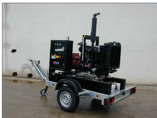
Rimorchio tipo BD 1400 GEUTR 1400 kg PTT con timone ad altezza regolabile a uso speciale gruppo elettrogeno
