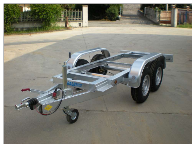
Rimorchio tipo BD 2500 TG3T-GV 2500 kg PTT – telaio 3000x1020 mm predisposto per applicazione gruppo elettrogeno
