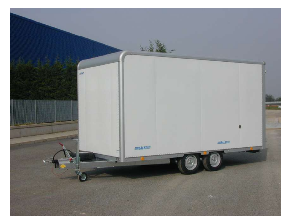
Rimorchio tipo BD 1400 MTR-F – 1700 kg PTT – furgonatura 4100x2000x2000 mm con portellone posteriore a doppio battente e porta laterale
