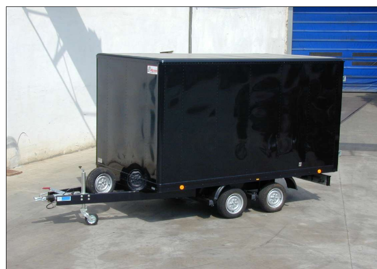
Rimorchio tipo BD 2000 MTF35 – 2000 kg PTT – Furgonatura 3500x2030x2000 mm con portellone posteriore a doppio battente. Verniciatura personalizzata
