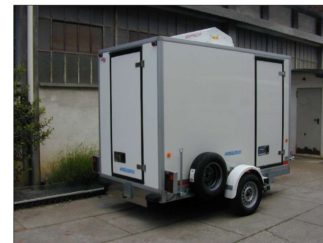
Rimorchio tipo BD 1800 MO-CO – 1800 kg PTT – furgonatura in vetroresina 3500x1500x2000 mm con porte laterale e posteriore a uso cella frigorifera per trasporti alimentari in condizioni ATP
