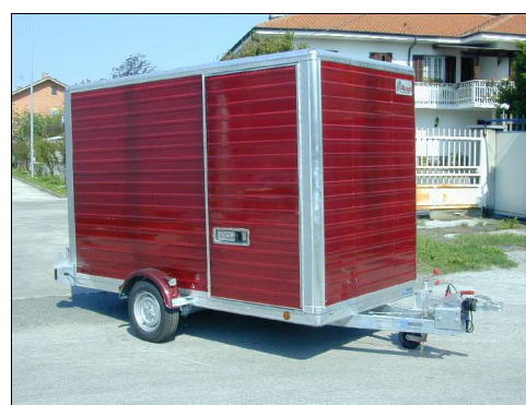
Rimorchi tipo BD 750 MFI – 750 kg PTT – furgonatura 3100x1500x2000 mm. Verniciature personalizzate
