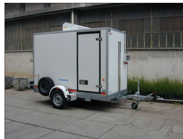
Rimorchio tipo BD 1800 MO-CO – 1800 kg PTT – furgonatura in vetroresina 3500x1500x2000 mm con porte laterale e posteriore a uso cella frigorifera per trasporti alimentari in condizioni ATP
