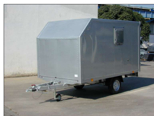
Rimorchio tipo BD 750 MF3 – 750 kg PTT – Furgonatura 3000x1730x1700 mm con parete anteriore sagomata
