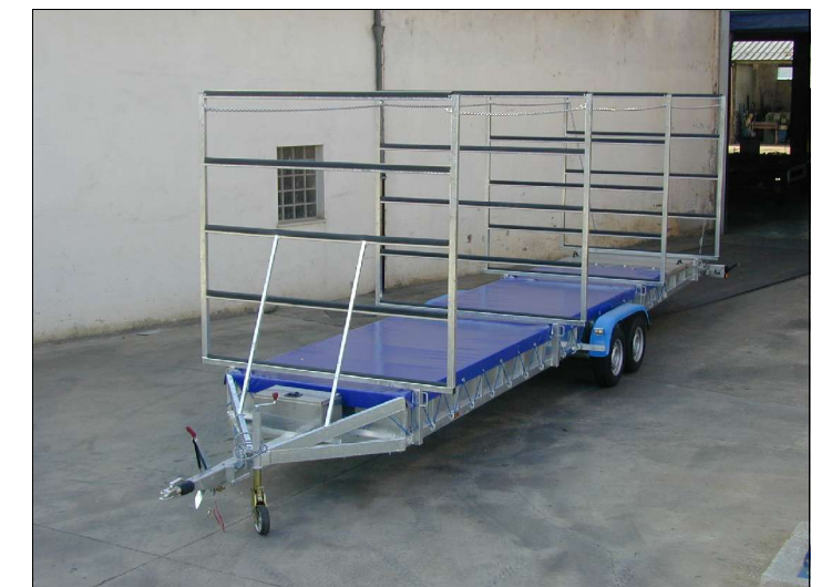
Rimorchio tipo BD 20 CAN con strutture di carico a 5 piani e scomparti larghi
