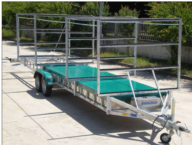
Rimorchio tipo BD 15 CAN con strutture di carico a 4 piani a scomparti larghi
