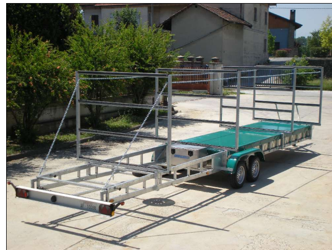
Rimorchio tipo BD 15 CAN con strutture di carico a 4 piani a scomparti larghi
