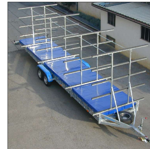
Rimorchio tipo BD 20 CAN con strutture di carico a 5 piani e scomparti stretti
