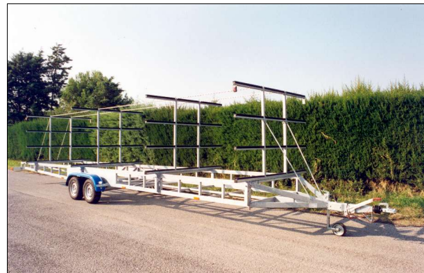
Rimorchio tipo BD 15 CAN con strutture di carico a 4 piani a scomparti stretti
