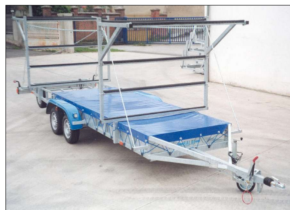
Rimorchio tipo BD 09 CAN con strutture di carico a 4 piani a scomparti larghi e mensole aggiuntive
