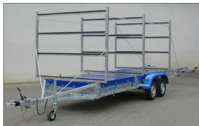
Rimorchio tipo BD 09 CAN con strutture di carico a 4 piani e scomparti larghi.
