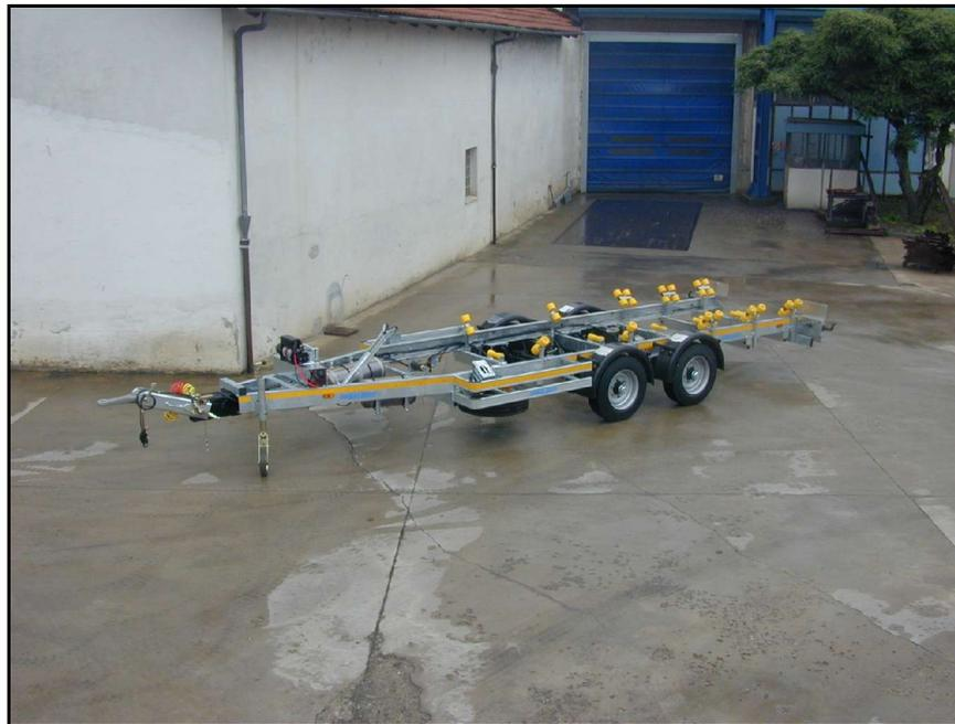
Rimorchio allestito con rulli centrali e laterali in poliuretano ad elevata resistenza – supporto fermoprua – argano elettrico
